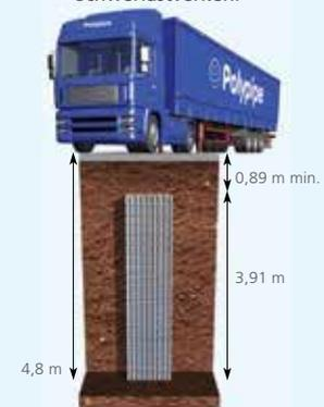
Hinweis: Die Mindestabdeckung und Verlegetiefen können je nach Last und Bodenbedingungen variieren. Weitere Auskunft erhalten Sie bei Polypipe. Bei Verwendung geeigneter Schutzvorrichtungen zur Reduzierung der auf die geplanten Polystorm-Gefüge einwirkenden Last können alle Polystorm-Produkte auch in Situationen außerhalb der oben empfohlenen Einsatzbereiche verwendet werden.
