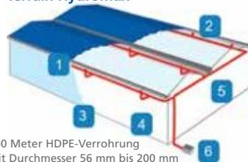
360 Meter HDPE-Verrohrung mit Durchmesser 56 mm bis 200 mm
